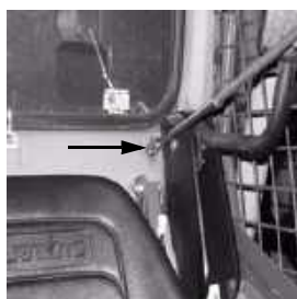
Figura 16 Se puede acceder a los dos pernos superiores en la pared posterior del ROPS/FOPS con el asiento en posición baja.
