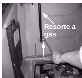
Figura 12 Ubicación de la tuerca que se debe retirar en el extremo de la base del resorte a gas. Además, retire la tuerca en el extremo de la varilla del resorte a gas.
