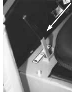
Figura 18 Control de la velocidad del motor
