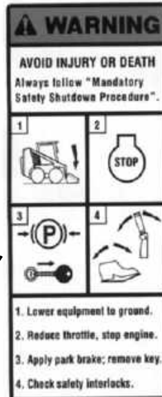
137683 – Ubicada en el tablero de control izquierdo de la ROPS
