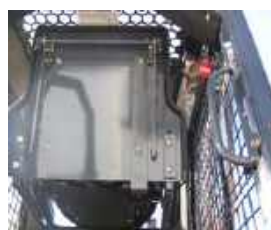
Figura 17 Ubicación de dos pernos del asiento utilizados para asegurar el soporte del tope del asiento (pieza N° 189834) a la placa del asiento. (La vista es del soporte del tope del asiento de suspensión instalado en la placa del asiento, debajo del asiento.)
