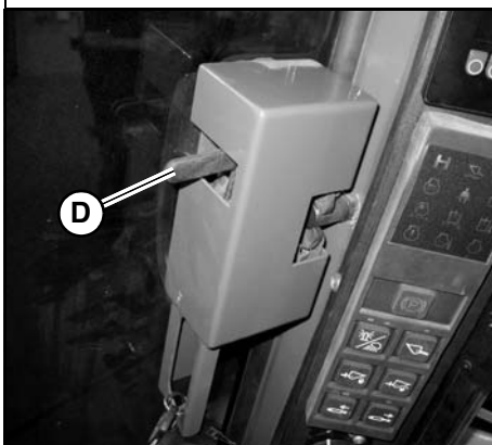
Figura 50 – Maneta interior de la puerta de la cabina
