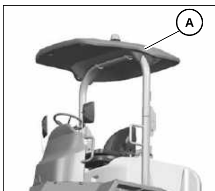
Fig.:70 Tejadillo de protección solar
